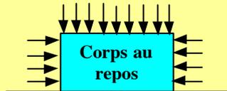
1/ **Corps au repos** : on appelle "pression statique PS", la pression exercée par l'air immobile sur toute la surface d'un corps au repos
