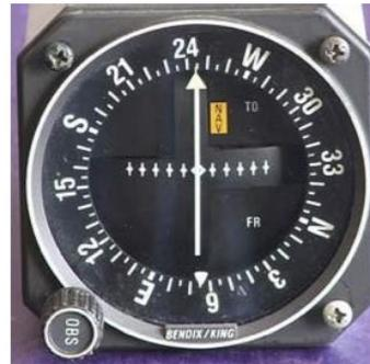
Le petit losange central représente l'avion, l'aiguille mobile représente la route sélectionnée. Le bouton "OBS" permet de sélectionner la route choisie en faisant tourner la couronne graduée
