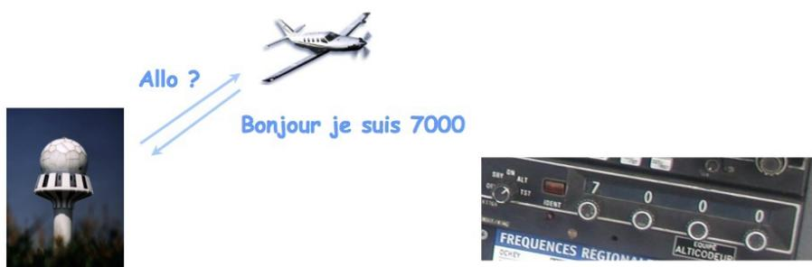
Il envoie à l'avion une interrogation à laquelle le **transpondeur** de bord fournit une réponse.
