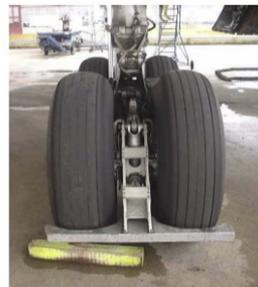
Le train est en général monté sur des dispositifs **amortisseurs** destinés à absorber l'impact à l'atterrissage.
