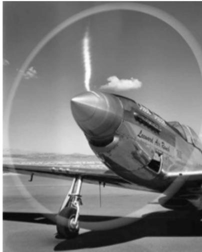
C'est un dispositif qui permet de transformer l'énergie mécanique fournie par le moteur en une force tractive ou propulsive directement utilisable par l'avion pour se déplacer.
