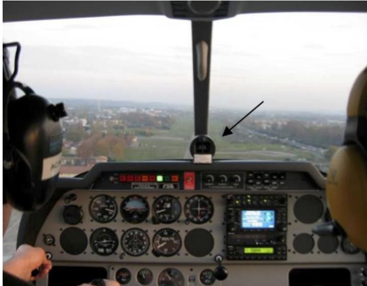
Il se compose d'un plateau circulaire gradué de 0 à 360°, associé à un aimant orienté sur l'axe Nord-Sud. L'ensemble est posé sur un pivot et baigne dans un liquide amortisseur qui limite les oscillations.
