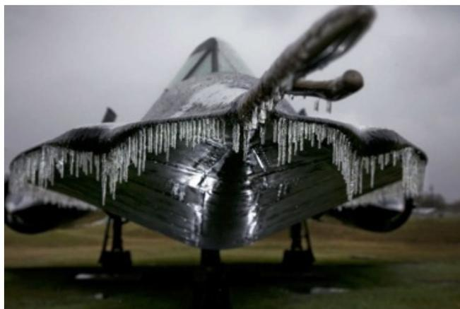
Le givrage est un phénomène dangereux pour l'aéronautique, pouvant avoir les conséquences suivantes : **alourdissement de l'avion, déformation des profils aérodynamiques → diminution de la portance et augmentation de la traînée, obstruction des capteurs et mise hors service des instruments correspondants, blocage d'une gouverne...**
